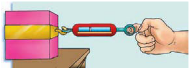
Figura 8.21. Método para determinar el tamaño de la fuerza de fricción.
