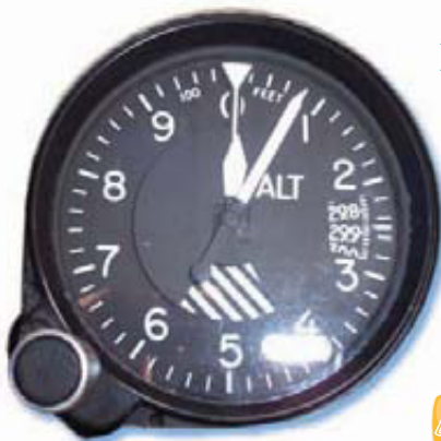
Figura 3.9. El altímetro proporciona la altura del avión basándose en la medición de la presión atmosférica alrededor del avión.
