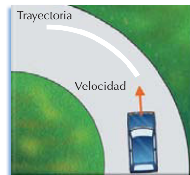
Figura 5.49. La dirección y el sentido de la velocidad en un movimiento curvilíneo.
