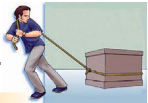
Figura 8.17. El esfuerzo necesario para iniciar el movimiento de la caja es mayor que el esfuerzo necesario para deslizarla.
