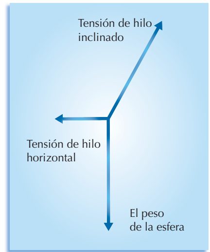
Figura 4.48. Los vectores de fuerzas para una esfera pesada colgada del techo con un hilo inclinado.
