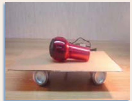
Figura 9.26. El arreglo que hace posible que la secadora se mueva al encenderla.
