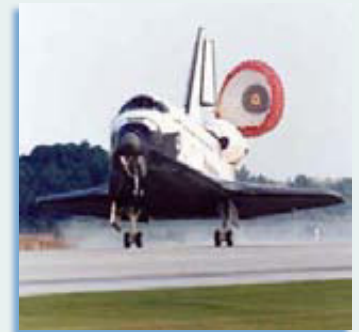
Figura 6.24. El paracaídas reduce la distancia de frenado.
